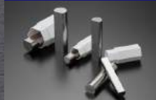
歯車測定用ピンゲージセット Pin Gauge Set for measuring gear wheels
